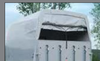
In 2 standen verstelbaar automatisch oprolbaar achterzeiltje (standaard) of een bovenklep
