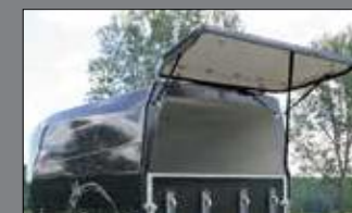
In 2 standen verstelbaar automatisch oprolbaar achterzeiltje (standaard) of een bovenklep
